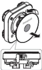
1. Verwijder het voorpaneel van de detectormodule zodat u bij de bevestigingsschroeven kunt:
