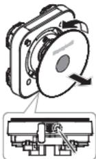
1. Снимите переднюю крышку с модуля датчика для доступа к крепежным винтам следующим образом:
