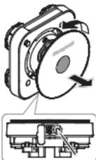
1. Die Frontabdeckung des Detektormoduls entfernen, um die Halteschrauben wie folgt freizulegen:
