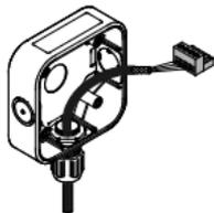
4. Branchez le câble à la plaque à bornes appropriée en consultant la section 2 à 4 en fonction de la version. Dénudez et insérez l'extrémité de chaque fil dans le trou de la borne correspondante et serrez la borne de fixation en utilisant un tournevis à lame plate jusqu'à ce que le fil soit fixé.
