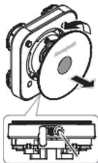
1. Retire la cubierta delantera del módulo detector para exponer los tornillos de retención de la siguiente manera:
