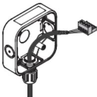
4. Ligue o cabo ao bloco de terminal adequado, consultando as secções de 2 a 4, dependendo da versão. Descarne e introduza a extremidade de cada fio no orifício de terminal correspondente e aperte o parafuso de terminal com uma chave de parafusos de terminal de lâmina plana até que o fio esteja fixo.
