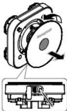
1. Retirez le cache avant du module du détecteur pour exposer les vis de fixation comme suit:
