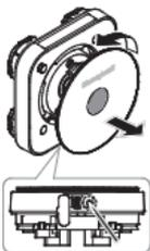
1. Remova a tampa frontal do módulo de detector para expor os parafusos de fixação da seguinte forma:
