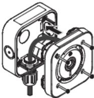
2. Placez le module du détecteur sur le boîtier arrière en vous assurant que l'indicateur de statut se trouve en haut à gauche vu de face.
