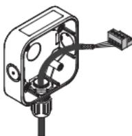
4. Collegare il cavo alla morsetteria corretta, facendo riferimento alla sezione da 2 a 4, secondo la versione. Spelare e inserire l'estremità di ciascun filo nel foro corrispondente della morsetteria, quindi serrare la vite con un cacciavite piatto fino a fissare il filo.
