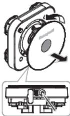
1. 将前盖从探测器模块上取下，露出固定螺钉，步骤如下：
