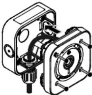
2. Coloque el módulo detector en la caja trasera asegurándose de que el indicador de estado esté en la esquina superior izquierda de la caja desde la parte delantera.
