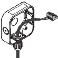
4. Das Kabel mit dem entsprechenden Klemmenblock verbinden, gemäß den Abschnitten 2 bis 4 (von der Version abhängig). Die Enden der Adern abisolieren und in die entsprechende Klemme einführen, die Klemmschraube mit einem Schlitzschraubendreher anziehen, bis die Ader befestigt ist.
