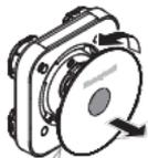
1. Retirer le capot avant du module de détection pour exposer les vis de fixation de la façon suivante :
