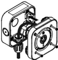
2. Posizionare il modulo rilevatore nella cassetta posteriore verificando che l'indicatore di stato si trovi nell'angolo superiore sinistro guardandolo dalla parte anteriore.
