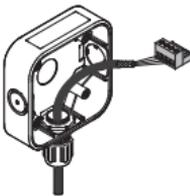
4. Verbind de kabel met het bijbehorende aansluitblok, waarbij u afhankelijk van de versie paragraaf 2 tot 4 raadpleegt. Strip en steek het eind van elke draad in het bijbehorende aansluitgat en draai de aansluitschroef vast met een platkopschroevendraaier tot de draad is bevestigd.
