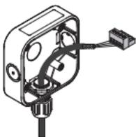
4. Подсоедините кабель к соответствующей клеммной колодке, см. разделы 2–4, в зависимости от версии. Оголите и вставьте конец каждого провода в отверстие соответствующей клеммы, затяните винт отверткой с плоским концом, чтобы надежно закрепить провод в клемме.
