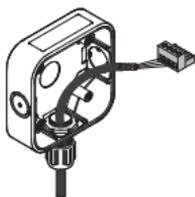
4. 将电缆连接至合适的接线端子，参见 2 至 4 节（取决于版本）。将每根电线末端的皮剥掉，并将其插入相应的端孔，然后使用平口螺丝刀拧紧端接螺钉，直至电线已固定。
