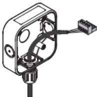
4. Conecte el cable al bloque de terminales apropiado; consulte las secciones 2 a 4 según la versión. Pele e inserte el extremo de cada cable en el orificio del terminal correspondiente y apriete el tornillo del terminal con un destornillador de punta plana hasta que el cable quede bien firme.
